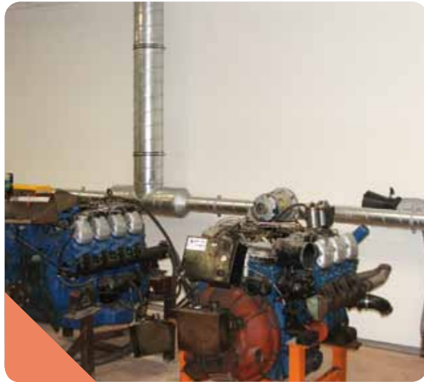
Banc d'essais moteurs Installation for motor test
